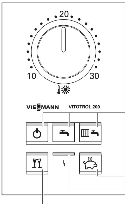
előírt érték beállító a „normál helyiség-hőmérséklethez”
